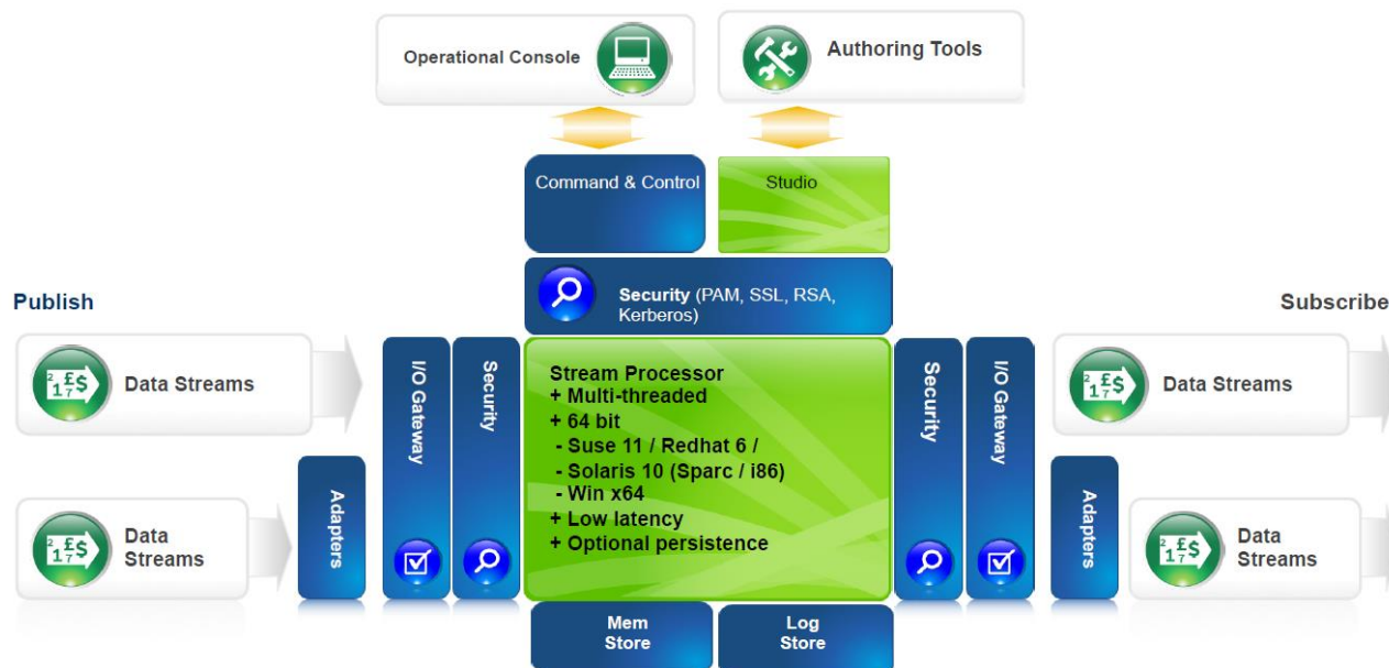
Рис. 11. Обобщённая архитектура SAP Sybase Event Stream Processing
